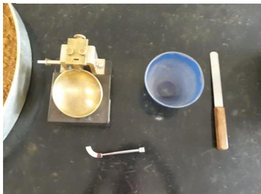
Figura 13. Ensaio de Limite de Liquidez.
