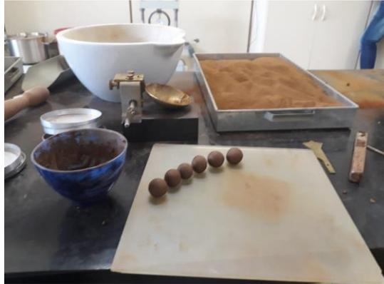
Figura 9. Ensaio Limite de Plasticidade.
