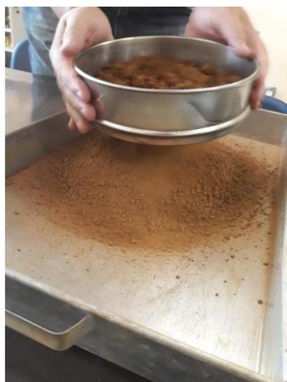
Após a secagem do material por 72 horas ao ar, destorroamento e peneiramento, em seguida foi coletado aproximadamente 600g de amostra destorroada, que passa na peneira de
