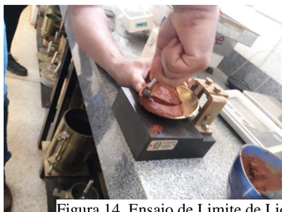
Figura 14. Ensaio de Limite de Liquidez.
