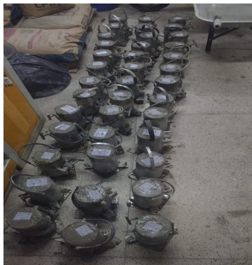
Figura 3 - moldagem dos corpos de prova.
