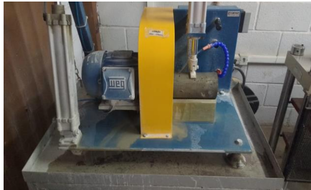
Figura 4 - retífica dos corpos de prova.
