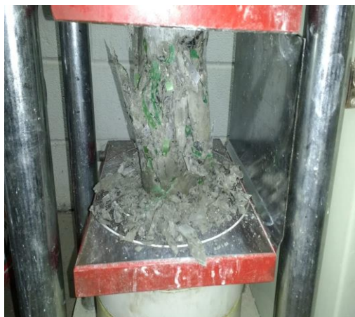
Figura 6 - Ensaio de resistência à compressão.
