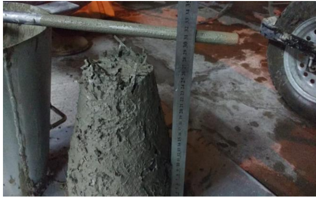
Figura 2 - Determinação do abatimento do concreto "Slump Test".
