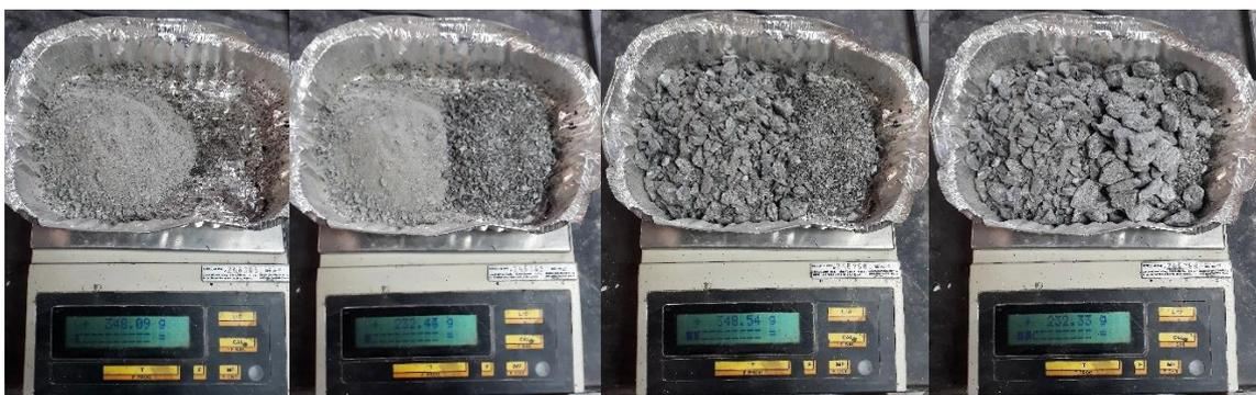
Figura 16. Composição Proporcional de Agregados.
