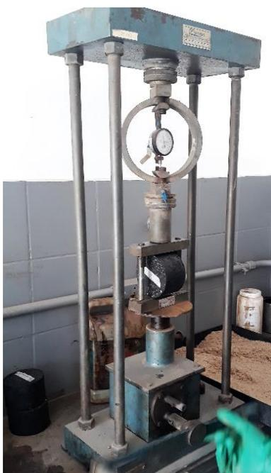
Figura 13. Prensa de Compressão Diametral.
