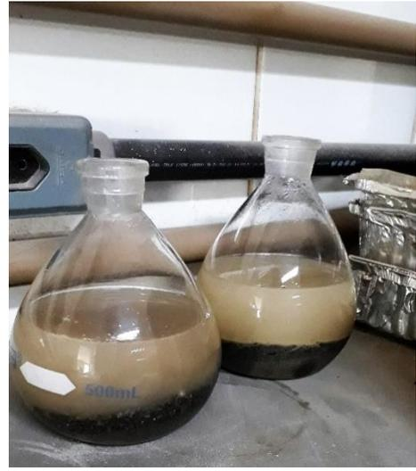
Figura 7. Densidade do agregado miúdo.
