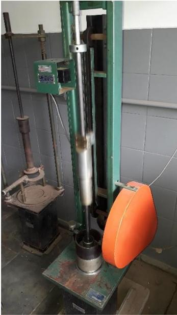
Figura 9. Compactação na Prensa Marshall.
