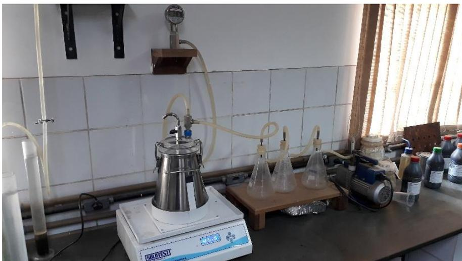
Figura 12. Aparelho do Rice Test.
