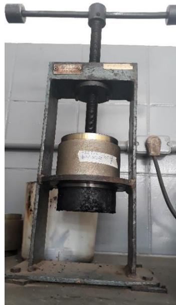
Figura 10. Extração do corpo de prova.
