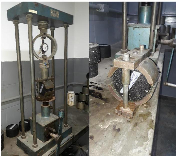
Figura 11. Prensa Marshall manual para rompimento dos corpos de prova.
