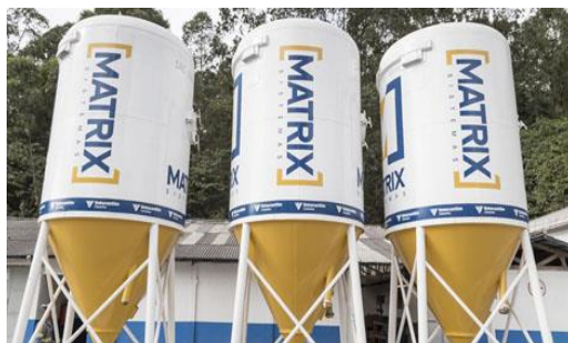
Figura 2 - Argamassa 2101 Matrix Revestimento Interno comercializada em Silos. Fonte: MAPA DA OBRA (2013)
