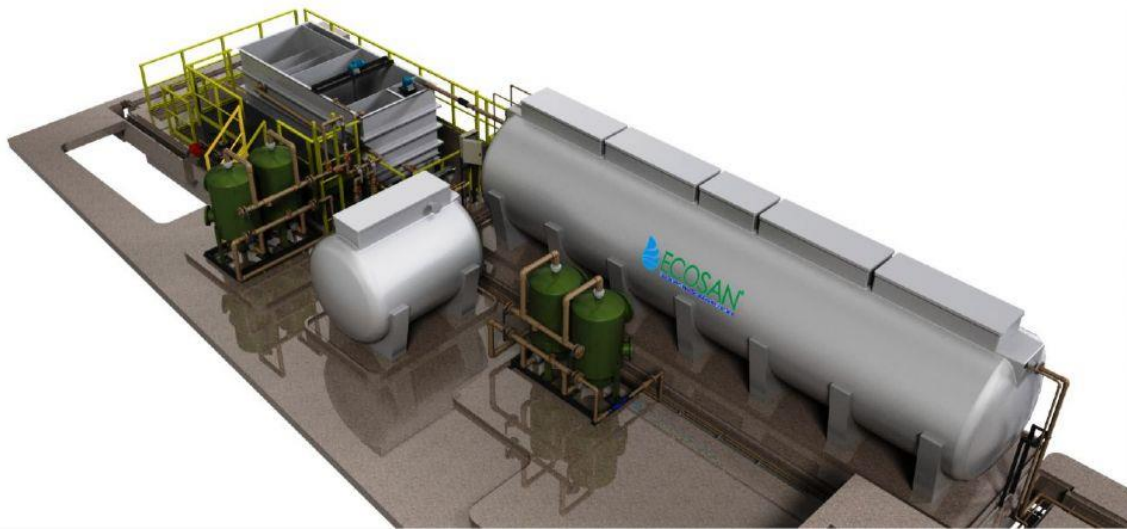
Figura 2: Projeto em 3D do Sistema de Tratamento de Reuso de Águas Pluviais e Águas Cinzas Fonte: ECOSAN (2016)
