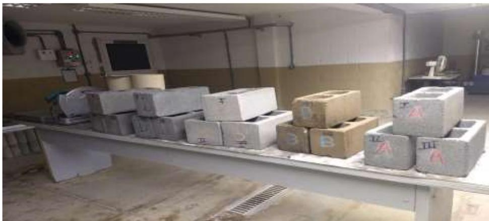
Figura 8. Blocos submetidos a análise dimensional
