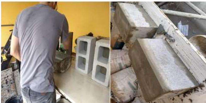
Figura 16. Capeamento dos blocos para ensaio de compressão
