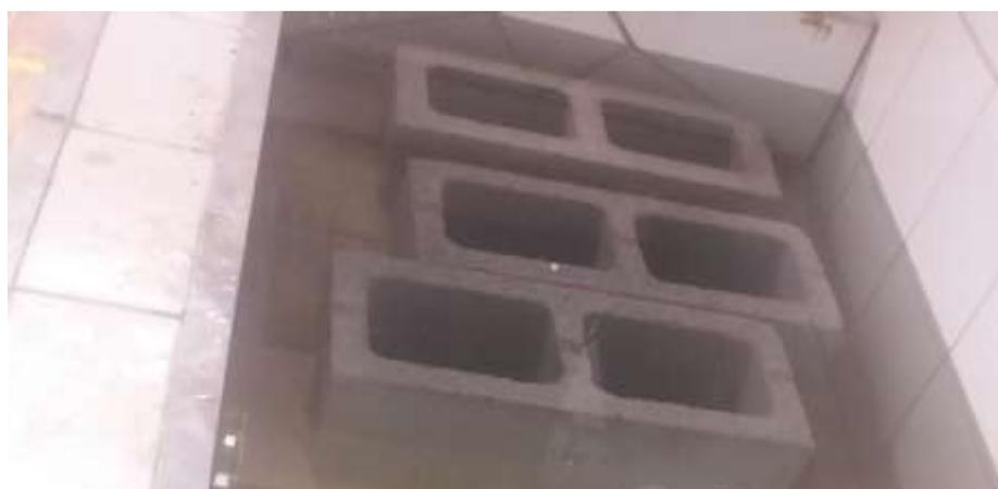
Figura 14. Blocos imersos em água para saturação
