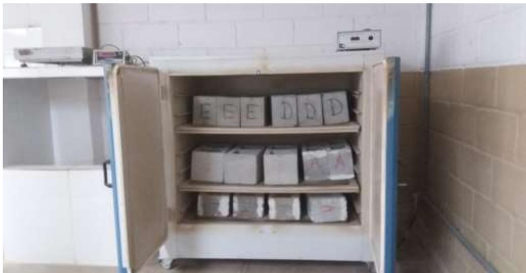
Figura 13. Blocos colocados na estufa para determinação da massa seca
