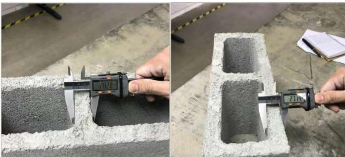
Figura 10. Determinação das espessuras longitudinais e transversais dos blocos
