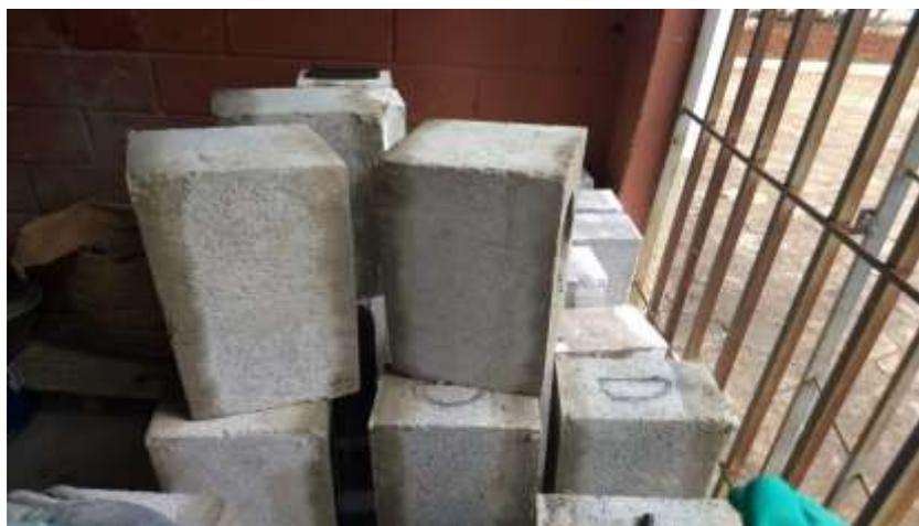
Figura 15. Blocos separados para ensaio de compressão
