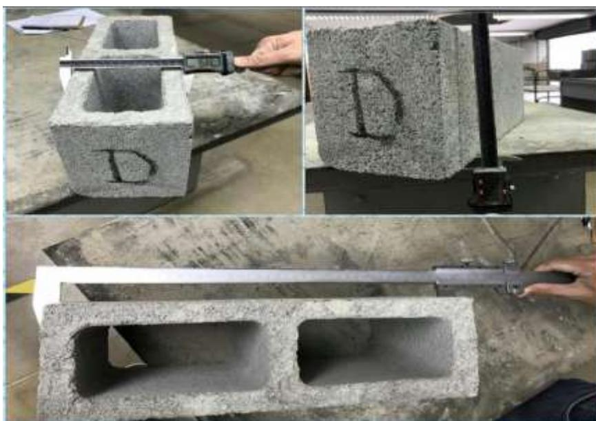
Figura 9. Determinação de largura, comprimento e altura das amostras.
