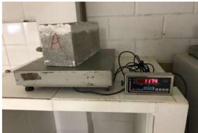
Figura 12. Determinação da massa “m” dos blocos
