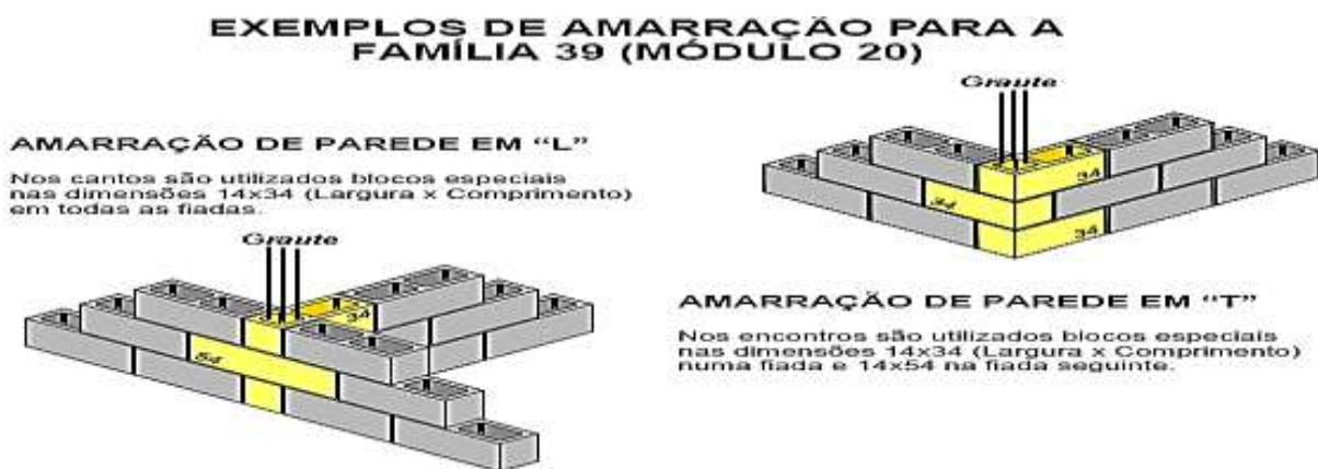
Figura 2. Amarração de blocos em L e em T
