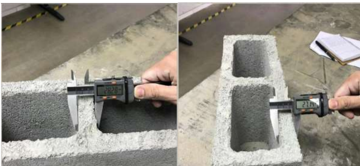
Figura 10. Determinação das espessuras longitudinais e transversais dos blocos Fonte: AUTORES (2018)
