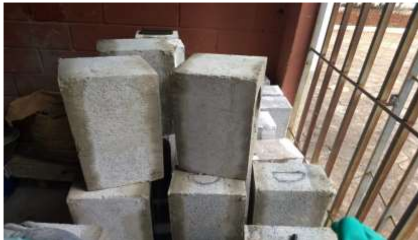
Figura 15. Blocos separados para ensaio de compressão Fonte: AUTORES (2018)
