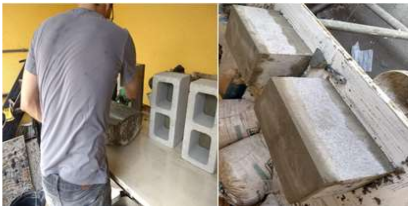
Figura 16. Capeamento dos blocos para ensaio de compressão Fonte: AUTORES (2018)
