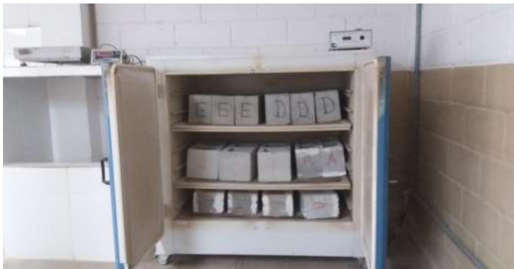
Figura 13. Blocos colocados na estufa para determinação da massa seca Fonte: AUTORES (2018)
