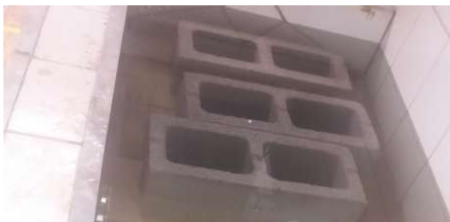
Figura 14. Blocos imersos em água para saturação Fonte: AUTORES (2018)
